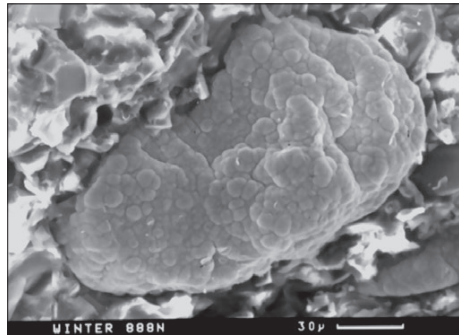
Металеве покриття алмазного зерна
