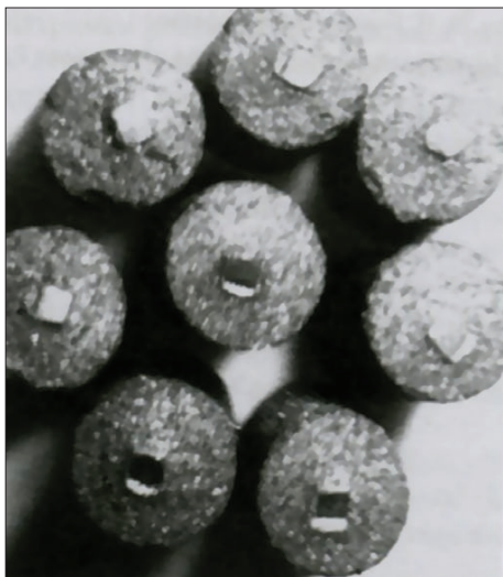
Зразки АПКМ з домішкою Ni-Co-WC, армовані пластиною полікристалічного CVD-алмазу (в центрі циліндрів) [18]
