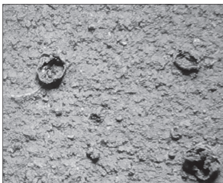
Сліди виплавлень зі зв'язки М1-10 після нанесення покриття
