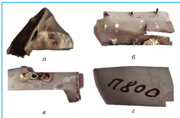
Фрагменти крилатих та авіаційних ракет виробництва країни-агресора: а – металеві фрагменти двигуна крилатої ракети ЗМ14 «Калібр»; б, в – фрагменти корпусів авіаційних ракет Р-37 та Р-31; г – фрагмент протикорабельної ракети П-800 «Онікс»
