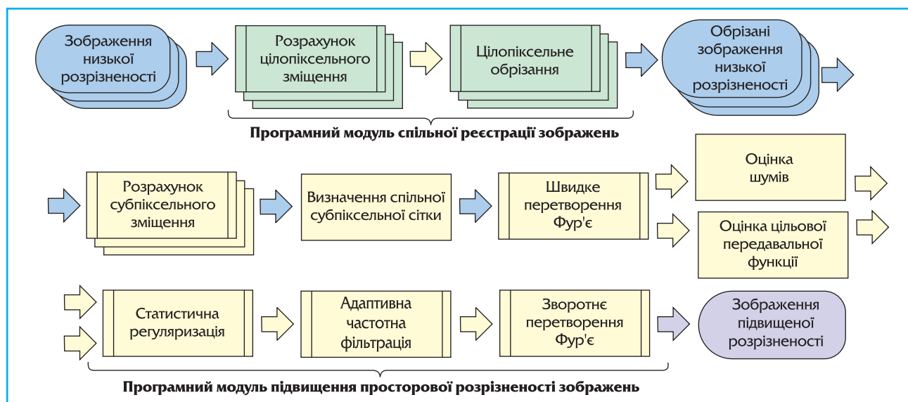
Потокова діаграма процесу оброблення субпиксельно зміщених супутникових зображень
