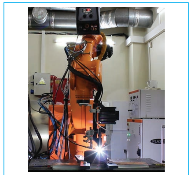
Роботизований комплекс для адитивного плазмово-дугового наплавлення виробів із титанових сплавів у контрольованій атмосфері
